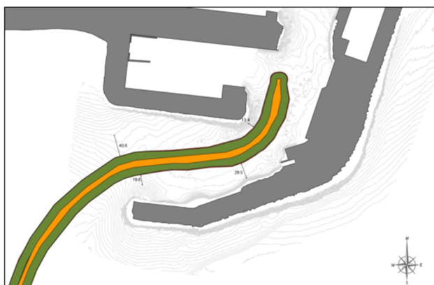
Figura 18. Espacio navegable seguro. Pesquero. Salida configuración actual. ABA-2.
