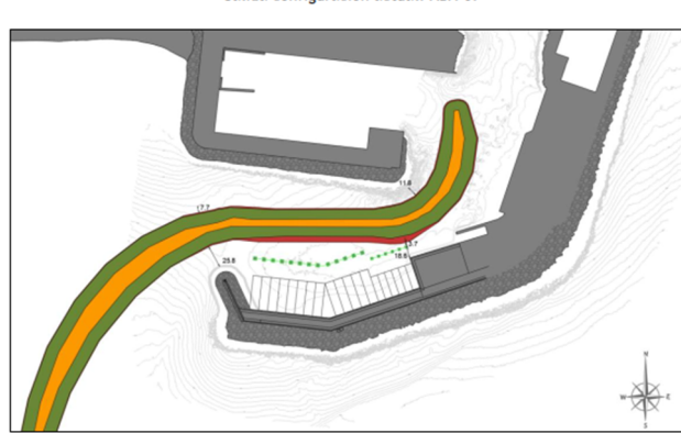
Figura 21. Espacio navegable seguro. Velero. Salida configuración futura. ABA-8.
