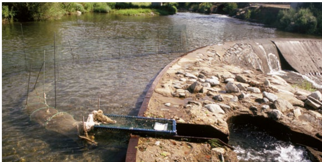
Figura 21. Paranys instal·lats a l'extrem superior dels dispositius de pas per a peixos del riu Ter a Camprodon (a dalt) i Torroella de Montgrí (a baix) l'any 2005 per avaluar-ne l'eficàcia. Fotos: Marc Ordeix-CERM.
