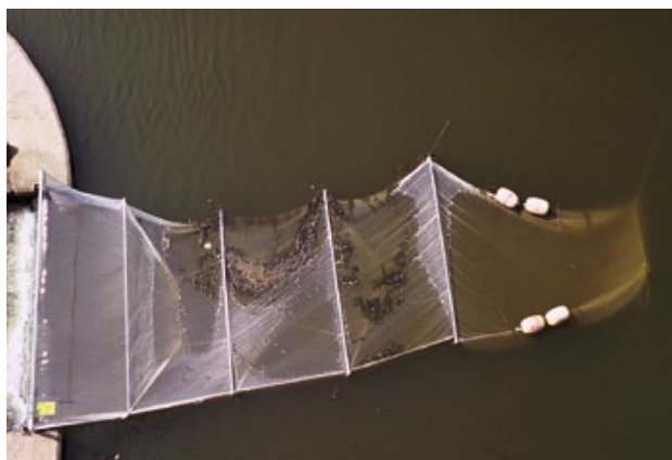
Figura 21. Paranys instal·lats a l'extrem superior dels dispositius de pas per a peixos del riu Ter a Camprodon (a dalt) i Torroella de Montgrí (a baix) l'any 2005 per avaluar-ne l'eficàcia. Fotos: Marc Ordeix-CERM.
