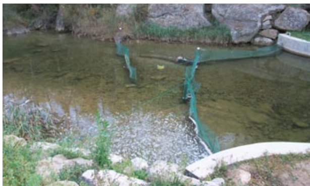
Figura 20. Imatges de l'estació d'aforament (EA110) de la riera de Merlès a Puig-reig (el Berguedà) (a la esquerra), en el moment de fer-hi una pesca elèctrica riu avall i, seguidament, una altra riu amunt, amb el propòsit de comparar-ne el poblament de peixos. També es mostra el parany instal·lat per avaluar-hi el trànsit de peixos aigua amunt (a la dreta), l'octubre de 2010. Fotos: Marc Ordeix-CERM.
