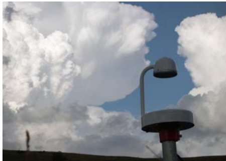
Sistema de prevenció PREVISTORM. Font: INGESCO.
