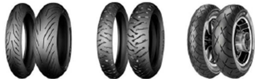
Evolución del dibujo, adaptado a cada tipo de motocicleta
