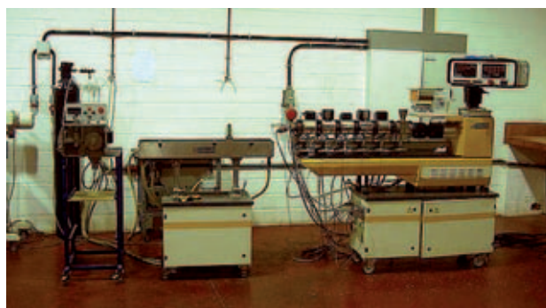
Figura 5. Esquema del conjunt extrusora-refrigeració-gransadora
