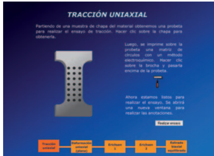
Figura 3. Pantalla amb la mostra preparada per realitzar l'assaig
