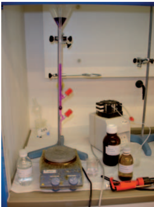
Figura 3. Detall de la valoració per determinar l'oxidabilitat
