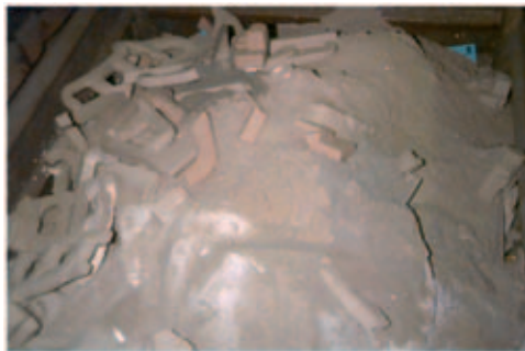
Figura 5. Terres d'emmotllament i de noios després del desemmotllament de les peces
