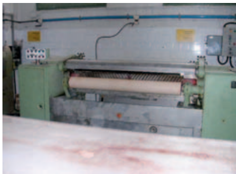
Figura 3. Màquina de descarnar
