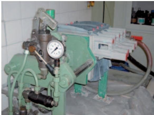
Figura 2. Filtre de premsa (bomba hidràulica)
