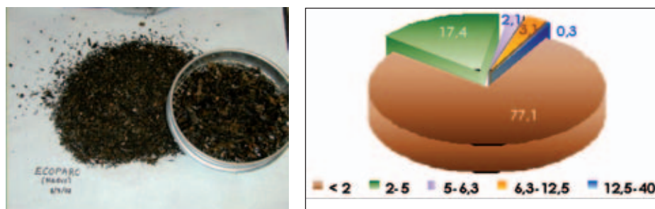
Figura 4. Exemple de determinació de la granulometria d'una mostra de compost de residus municipals
