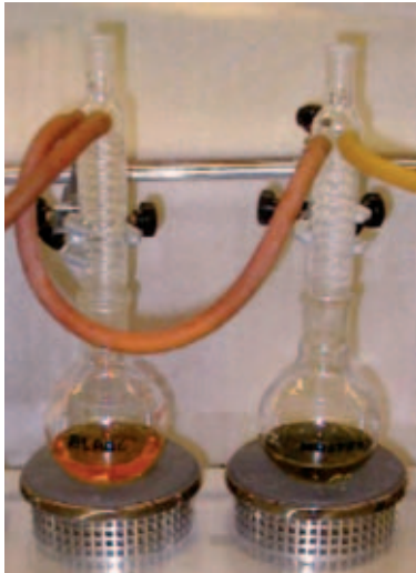
Figura 1. Digestió de mostres segons el mètode tradicional de determinació de la DQO a reflux obert. El baló de la dreta conté la solució de la mostra, i el de l'esquerra és la solució de referència, que es coneix com a «blanc». El color del «blanc», que conserva el taronja original del dicromat, contrasta amb el verd de la solució de la mostra, a causa de la reducció del dicromat a crom trivalent.
