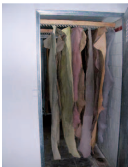
Figura 8. Assecador de bomba de calor o només amb aire ambient (si no es posa en marxa, la bomba de calor només fa passar l'aire ambient).
