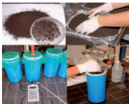
Figura 8. Materials i preparació del test d'autoescalfament
