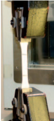
Figura 1. Proveta fixada a les mordasses de la màquina d'assajos
