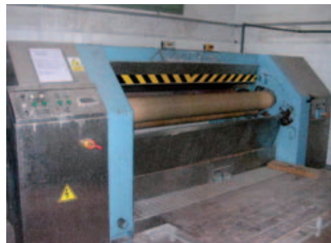
Figura 6. Màquina d'escórrer i de repassar alhora
