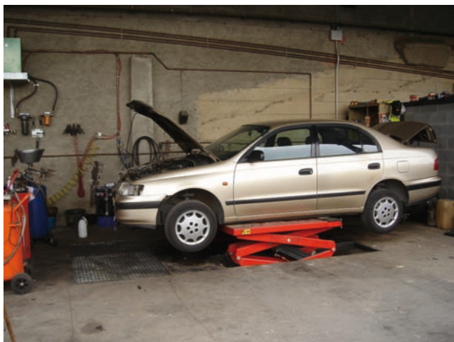
DESCONTAMINACIÓ: aparells elevadors
