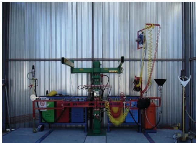
Equips d'extracció de fluids mitjançant aspiració
