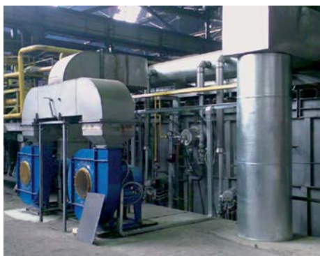
Figura 63. Forn d'escalfament de lingots de coure i llautó [12]
