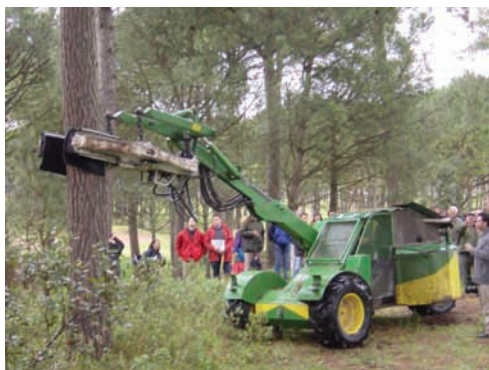
Aprofitament de pinya amb màquina vibradora SIGMA F3
