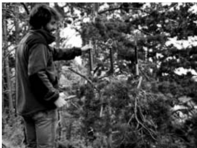
Figura 3.4. Obtenció del pes d'una branca amb un dinamòmetre en una parcel·la de l'IEFC
