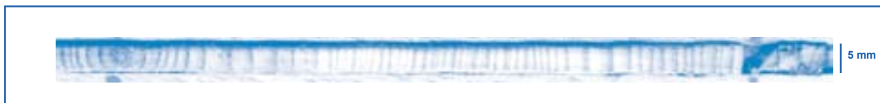
Figura 4.7. Imatge escanejada d'un testimoni de fusta de pi roig
