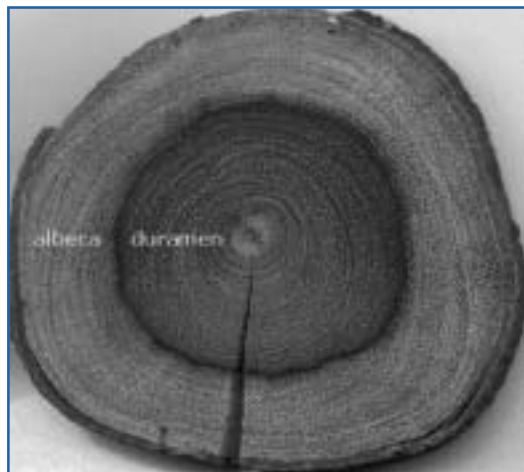
Secció transversal del tronc de Prosopis pallida (Piura, Perú) mostrant l'albeca i el duramen.
