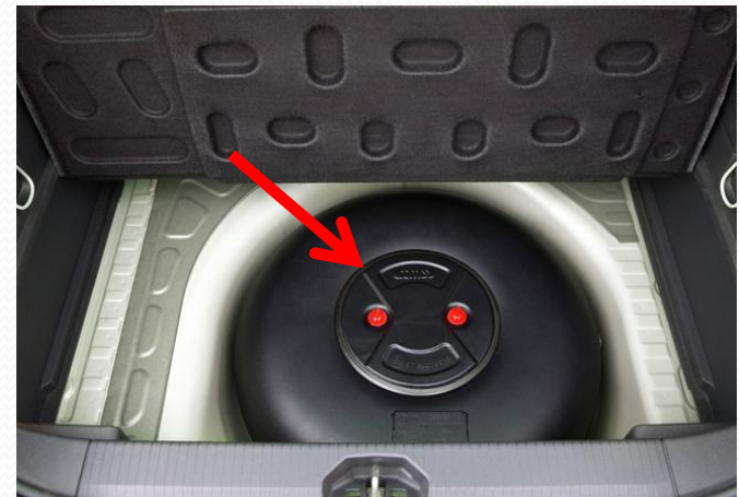
Tapa estanca deposito toroidal.
