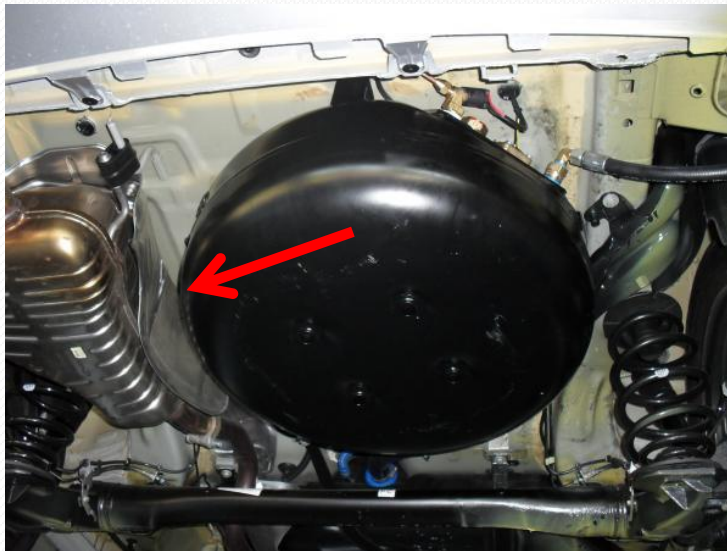
Depósito de combustible GLP cercano al silencioso de escape.
