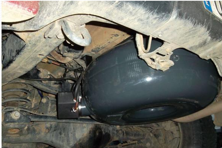
Depósito de combustible GLP en los bajos del vehículo.
